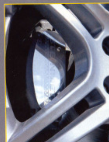
308 Millimeter messen die Bremsscheiben an der Front
