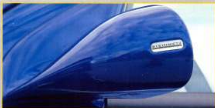
Elektrisch verstellbare und beheizbare Steinmetz-Spiegel
