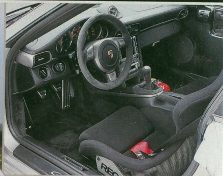
Serien-Cockpit mit Karbon-Türverkleidungen, die neun Kilo sparen
